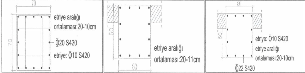
C Blok Bodrum kat D-15 aksı kolonu
